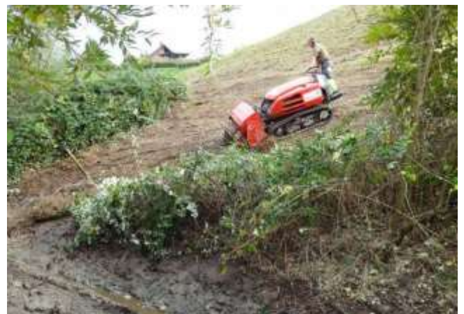
Schlegelmulcher im Einsatz gegen Brombeeren
